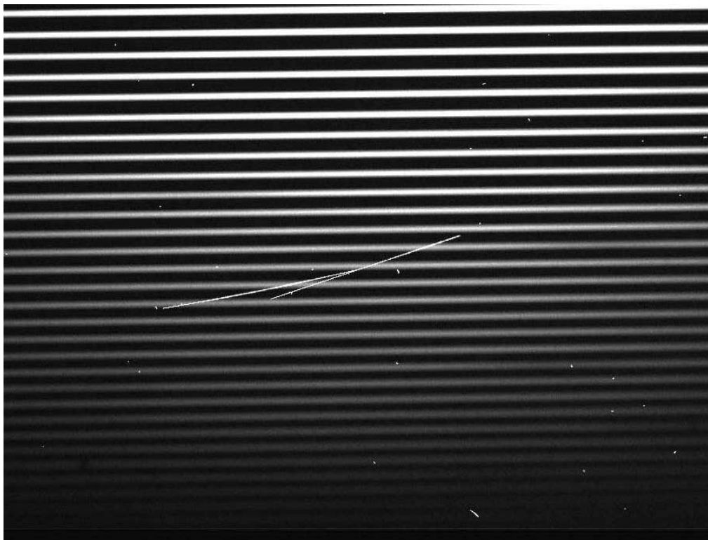
Рисунок 2 — Пример экстремального зашумления участка эшелле-спектра треками космических частиц при длительной экспозиции
