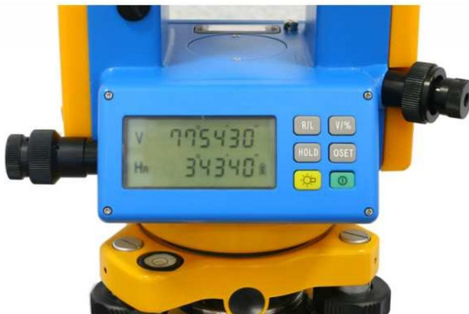
Рисунок 4.2 – Отсчетное устройство и пульт управления теодолитом GeoBox TE-02
