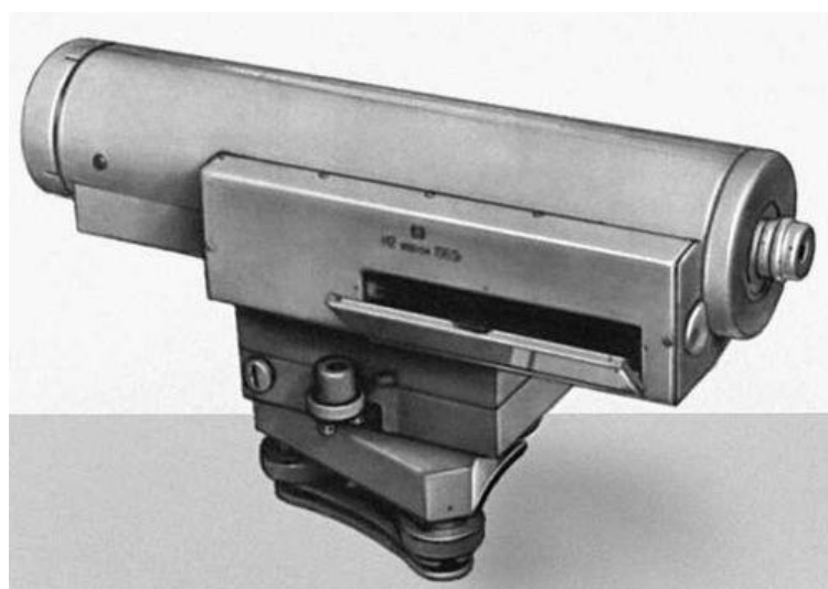
Рисунок 1 – Высокоточный глухой нивелир Н 2
