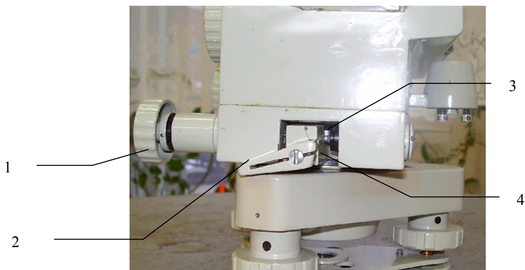
Рис.2.3.3 Регулировка плавности вращения нивелира вокруг вертикальной оси:
