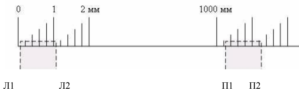
Рис. 4.2.5 Определение погрешности метровых интервалов с помощью нормальной линейки:
