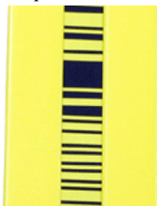
Рис.3.2.4 Инварная рейка с электронно-цифровой шкалой
