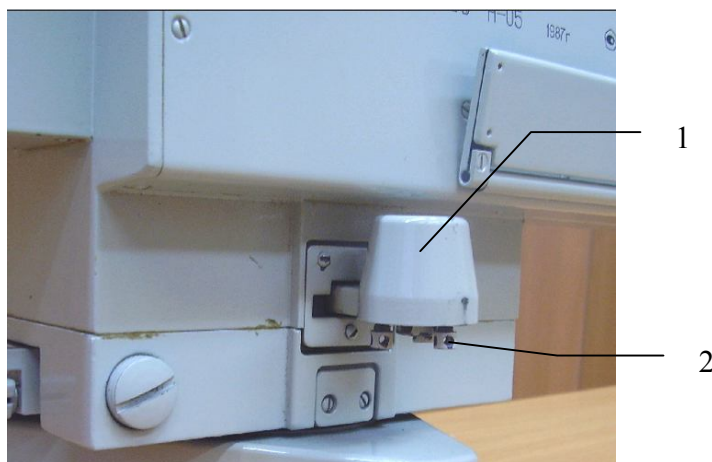
Рис.2.2 Регулировка установочного уровня:
